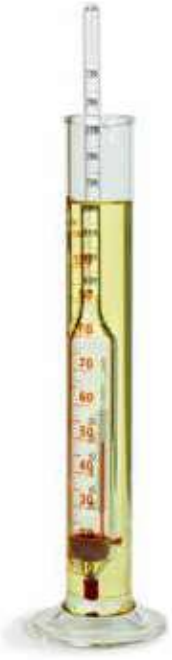
الشكل (15): أداة الهيدروميتر لقياس كثافة السوائل.
